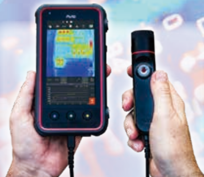
赤外線サーモグラフィ
